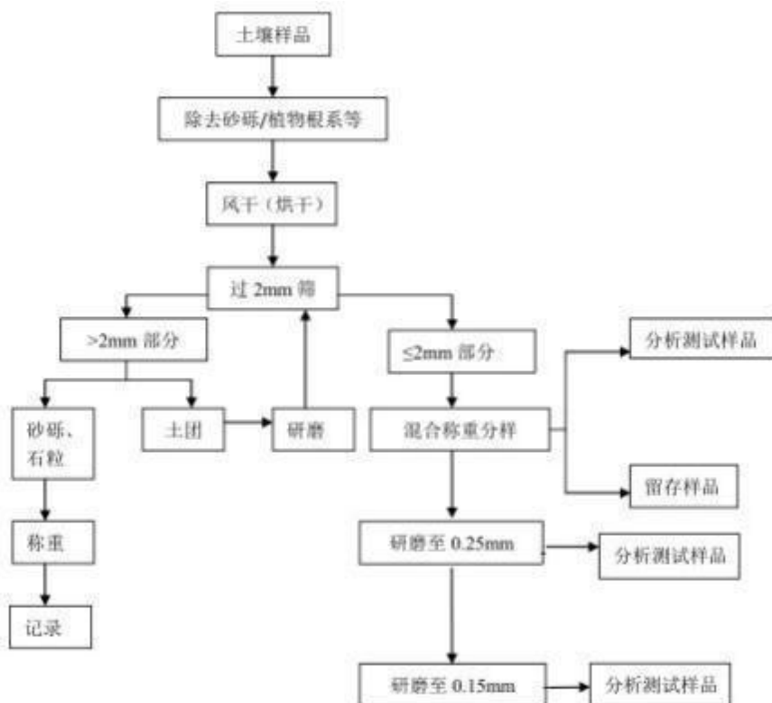
图7.3-5土壤制备过程流程图
